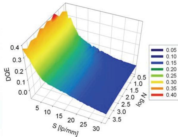
Fig. 4 Frequency-dependent DQE (Binning 1, 200kV) of the Gatan UltraScan.
